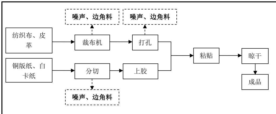
工艺流程概述：将外购的原料（纺织布、皮革）经裁布机、电钻切割、打孔加工成所需形状；再将铜版纸、白卡纸分切后通过上胶机进行上胶再与纺织布或皮革进行粘贴，经晾干后打包即得成品。
