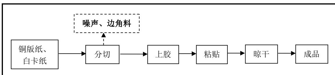
工艺流程概述：将外购的原料（铜版纸、白卡纸）经模切机分切后通过上胶机进行上胶（胶水使用水性丙烯酸乳液，常温下不挥发）再相互进行粘合，经晾干后打包即得成品。
