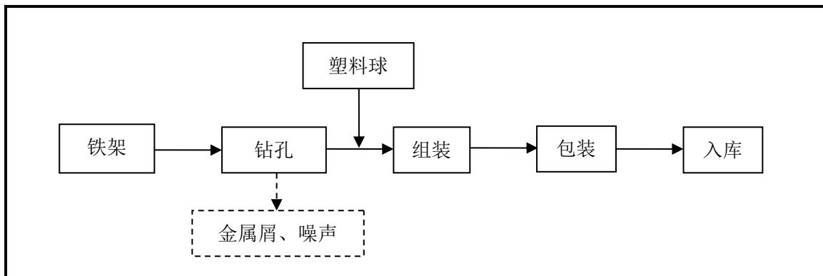
工艺流程概述：将外购的铁架经台钻进行钻孔，再与塑料球进行人工组装，包装后即得成品。
