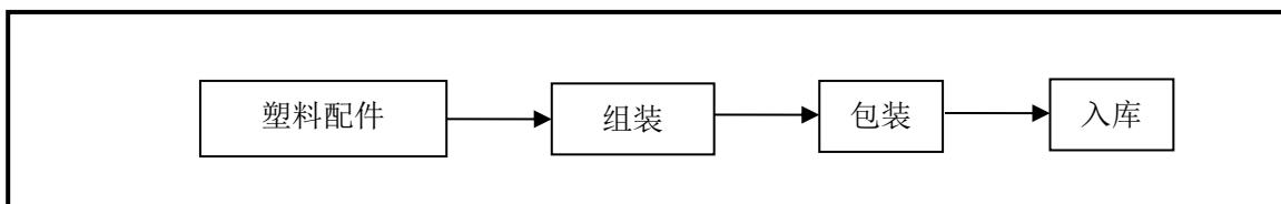
工艺流程概述：将外购的塑料配件进行人工组装，再经包装后即得成品。
