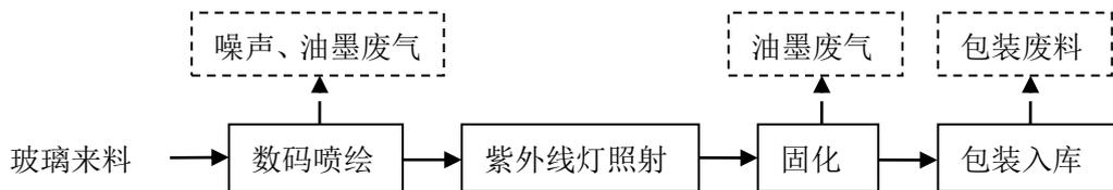
图 5-1 本项目玻璃来料彩印生产工艺流程及产污环节示意图
