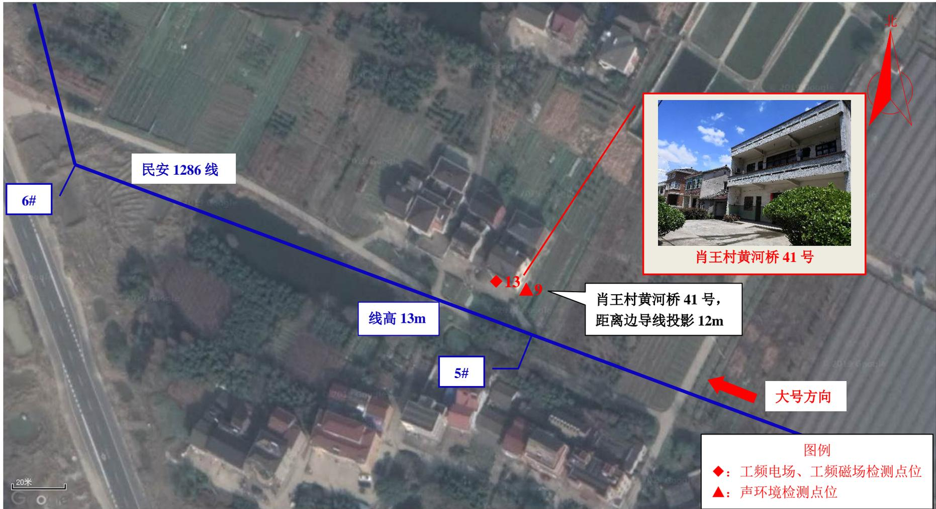
图 7-24 110kV 长安输变电工程检测点位示意图 (4)
