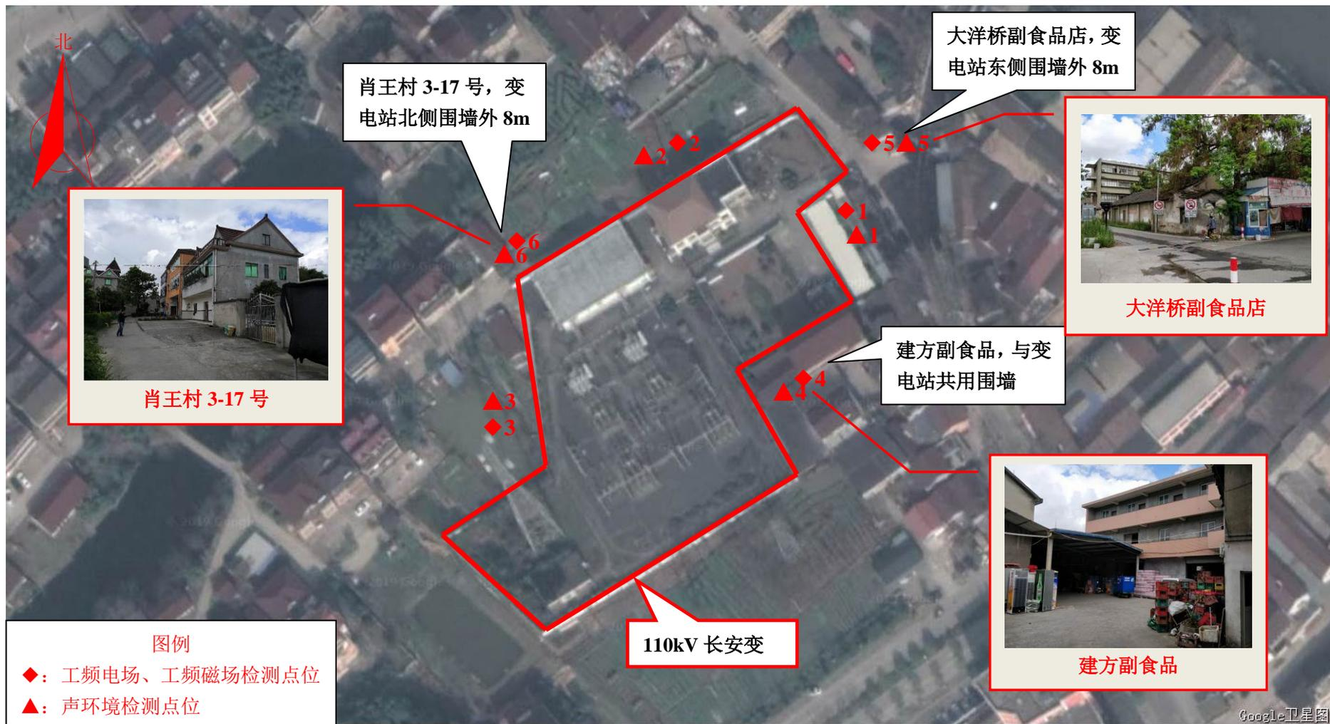
图 7-21 110kV 长安输变电工程检测点位示意图 (1)
