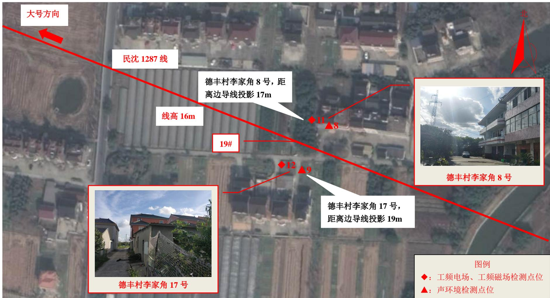
图 7-7 220kV 民谊变 110kV 送出工程检测点位示意图 (7)
