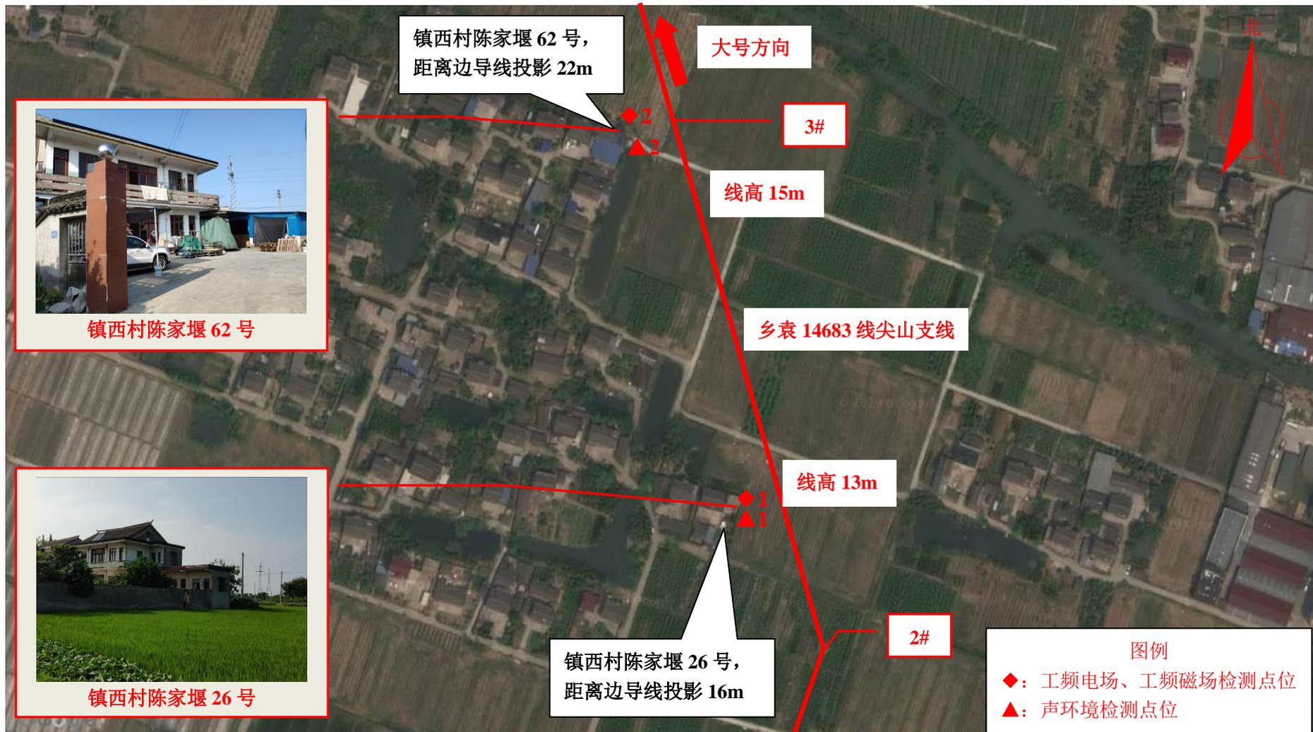
图 7-30 110kV 尖山输电线路工程检测点位示意图 (1)
