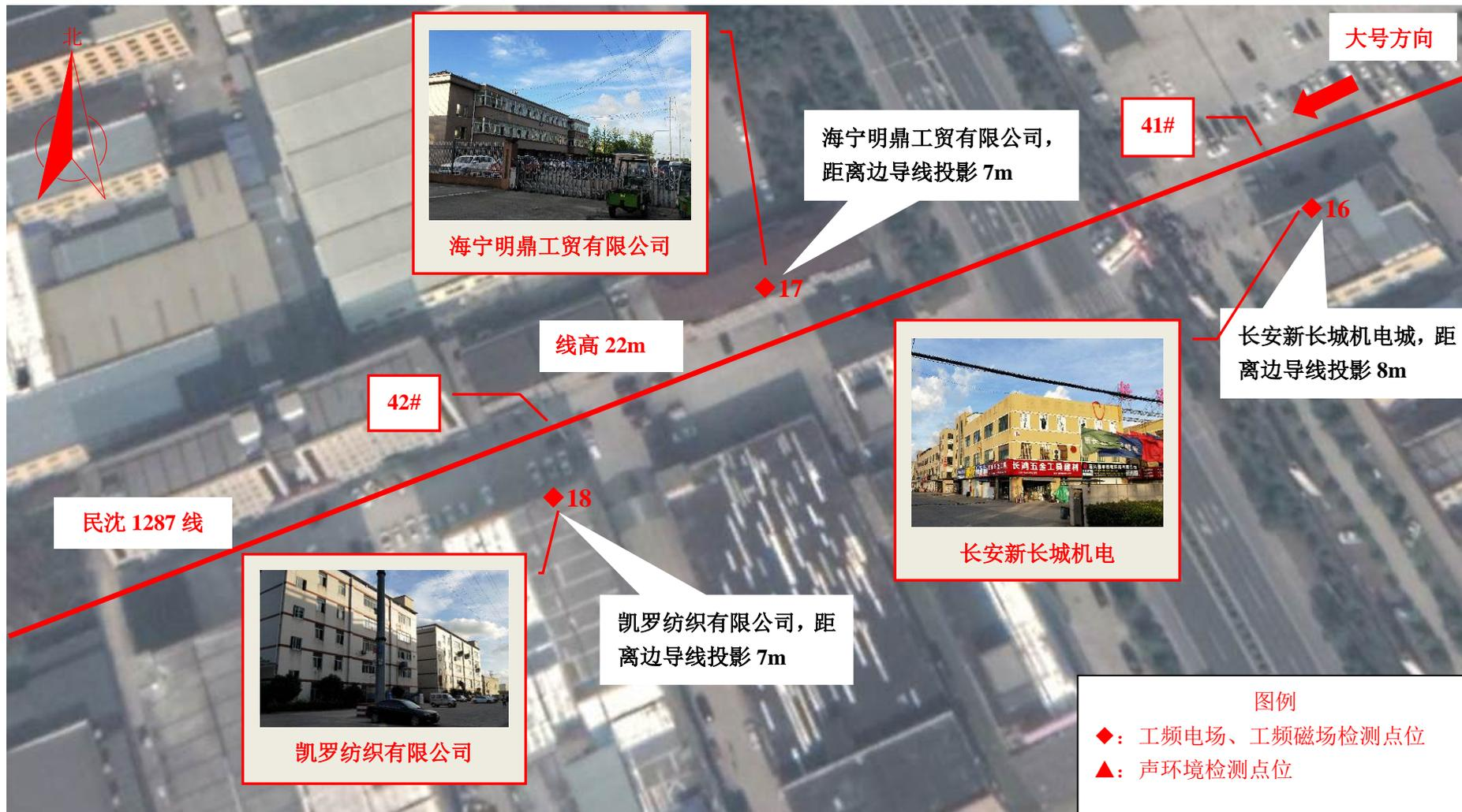
图 7-10 220kV 民谊变 110kV 送出工程检测点位示意图 (10)
