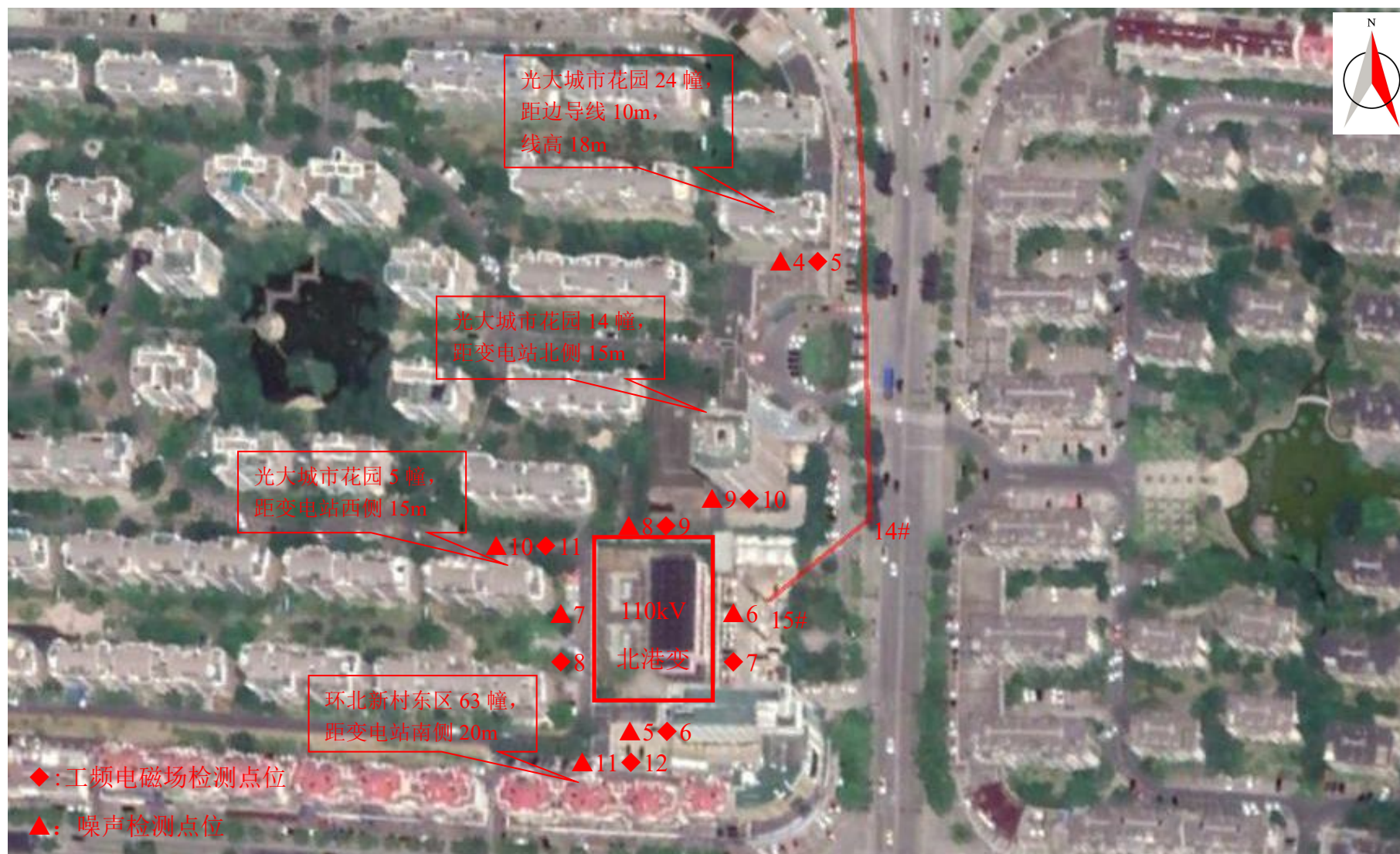
图 7-5 (3) 现场监测点位图 (110kV 北港输变电工程)
