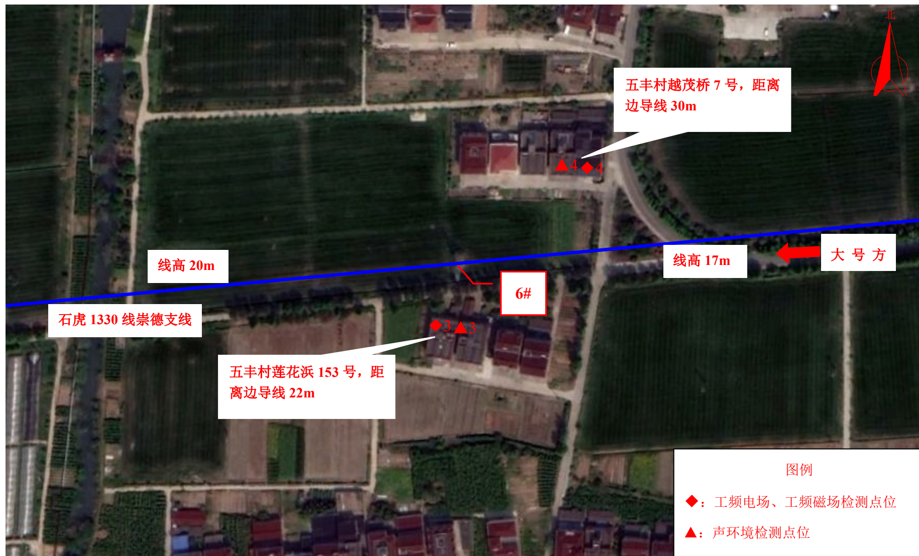
图 7-2 (2) 现场监测点位图 (110kV 崇德输电线路工程)
