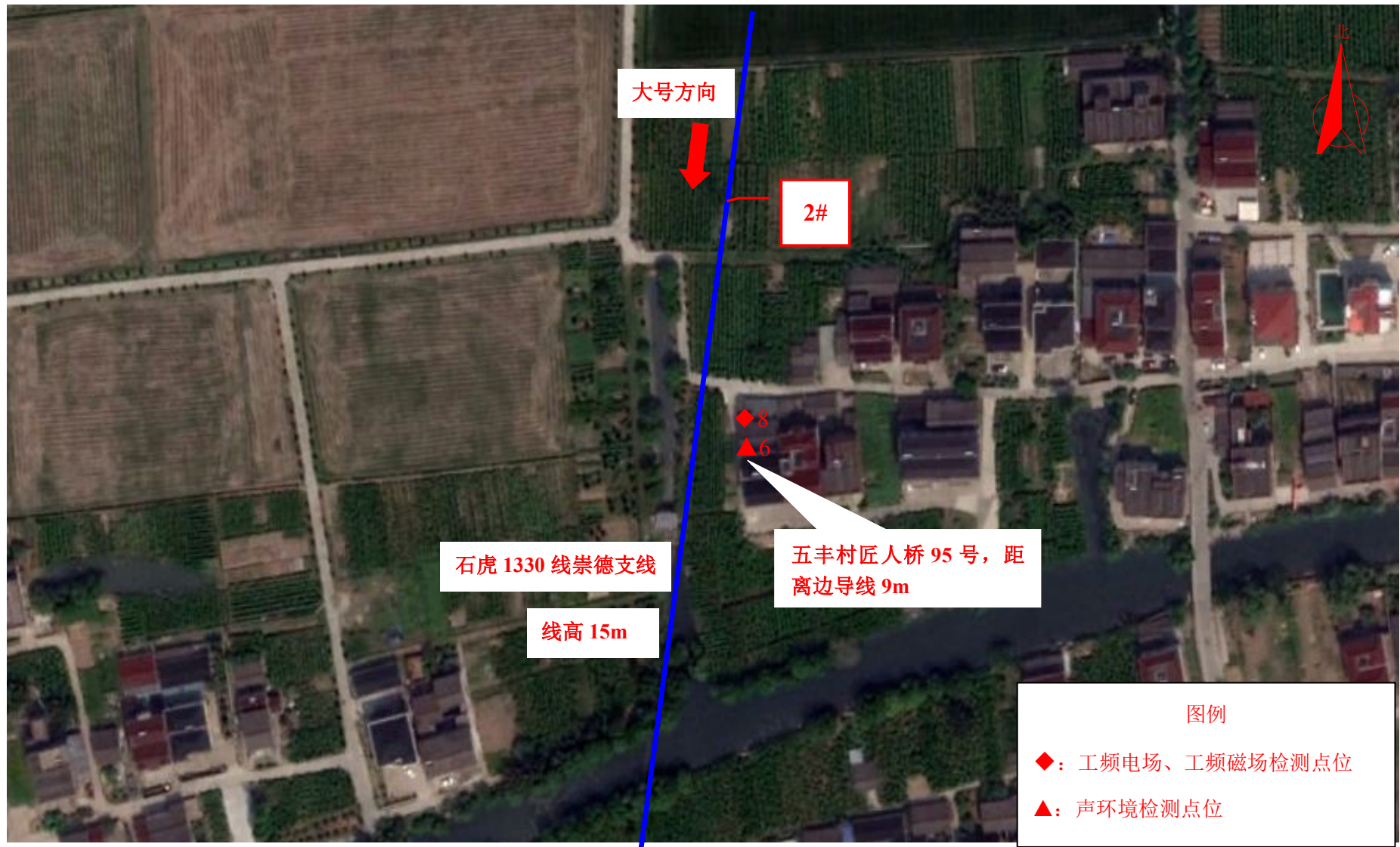
图 7-2 (4) 现场监测点位图 (110kV 崇德输电线路工程)
