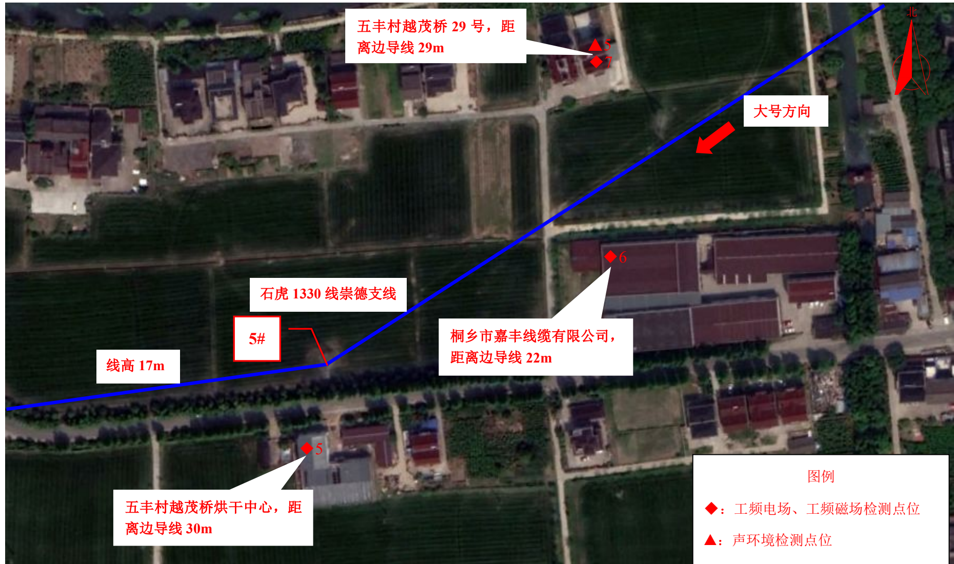
图 7-2 (3) 现场监测点位图 (110kV 崇德输电线路工程)
