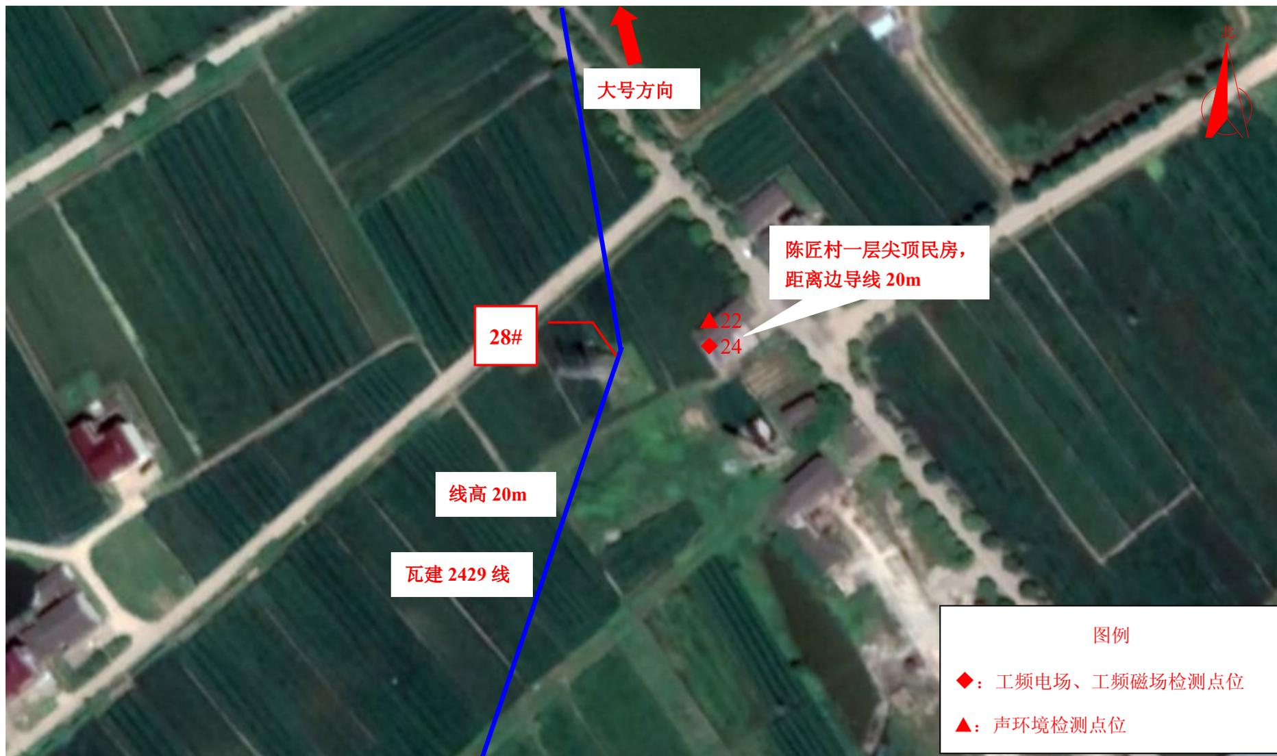
图 7-9 (16) 现场监测点位图 (220kV 瓦山输变电工程)
