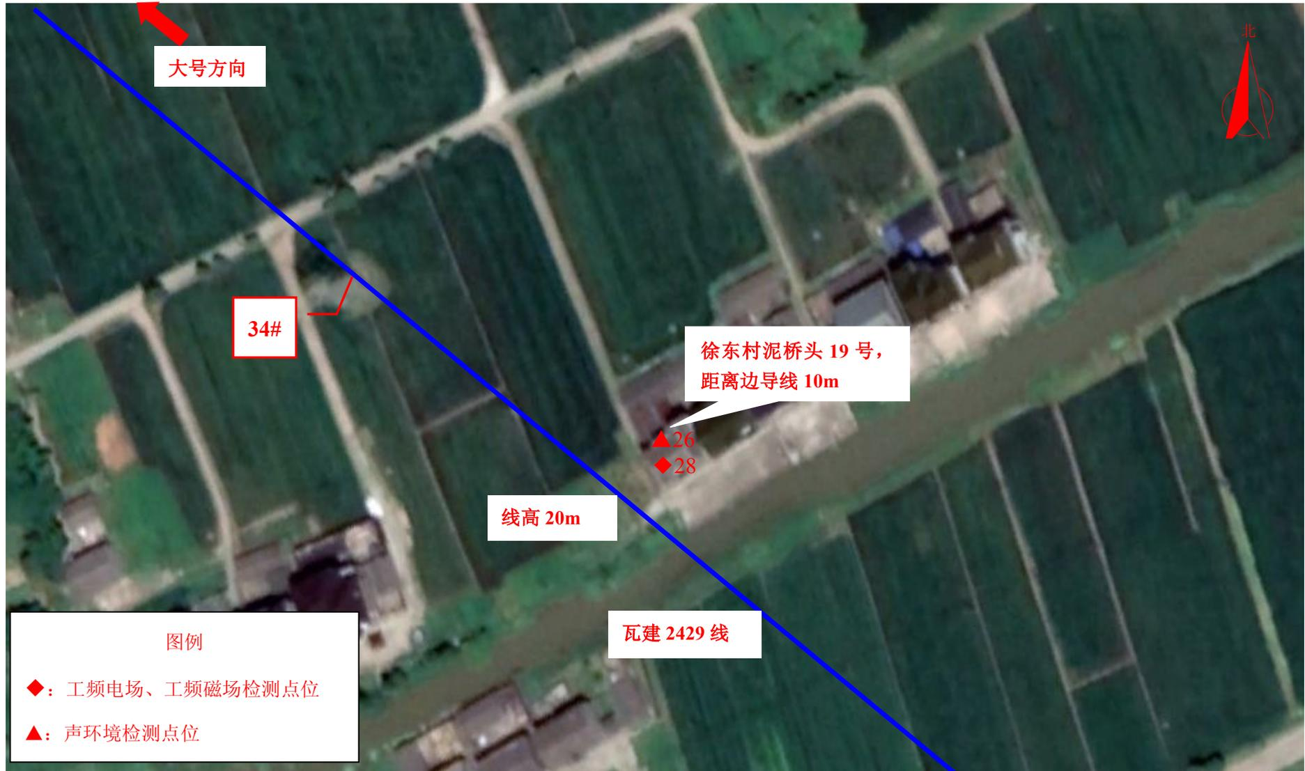
图 7-9 (20) 现场监测点位图 (220kV 瓦山输变电工程)
