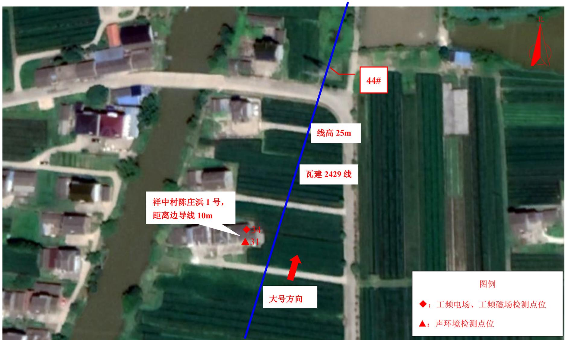
图 7-9 (25) 现场监测点位图 (220kV 瓦山输变电工程)
