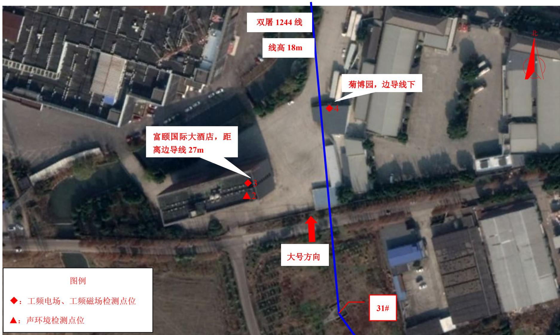
图 7-8 (2) 现场监测点位图 (110kV 双屠 1244 线输电线路工程)
