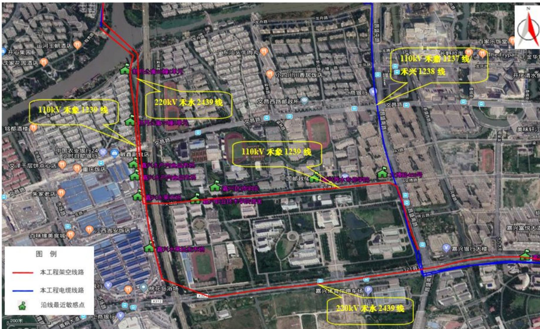
图 4-6 (2) 工程线路路径图 (220kV 禾水 2439 线、110kV 禾嘉 1237 线、110kV 禾兴 1238 线、110kV 禾象 1239 线)
