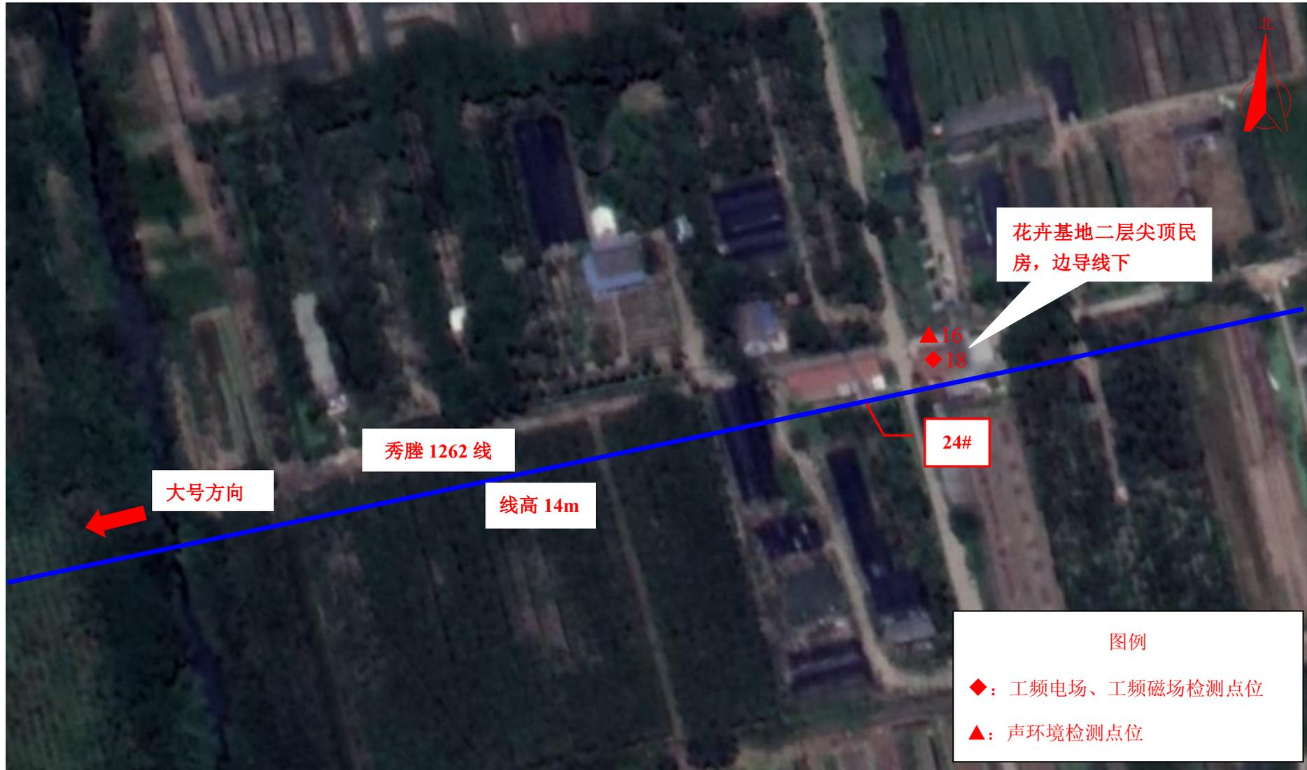
图 7-6 (9) 现场监测点位图 (110kV 新塍输电线路工程)
