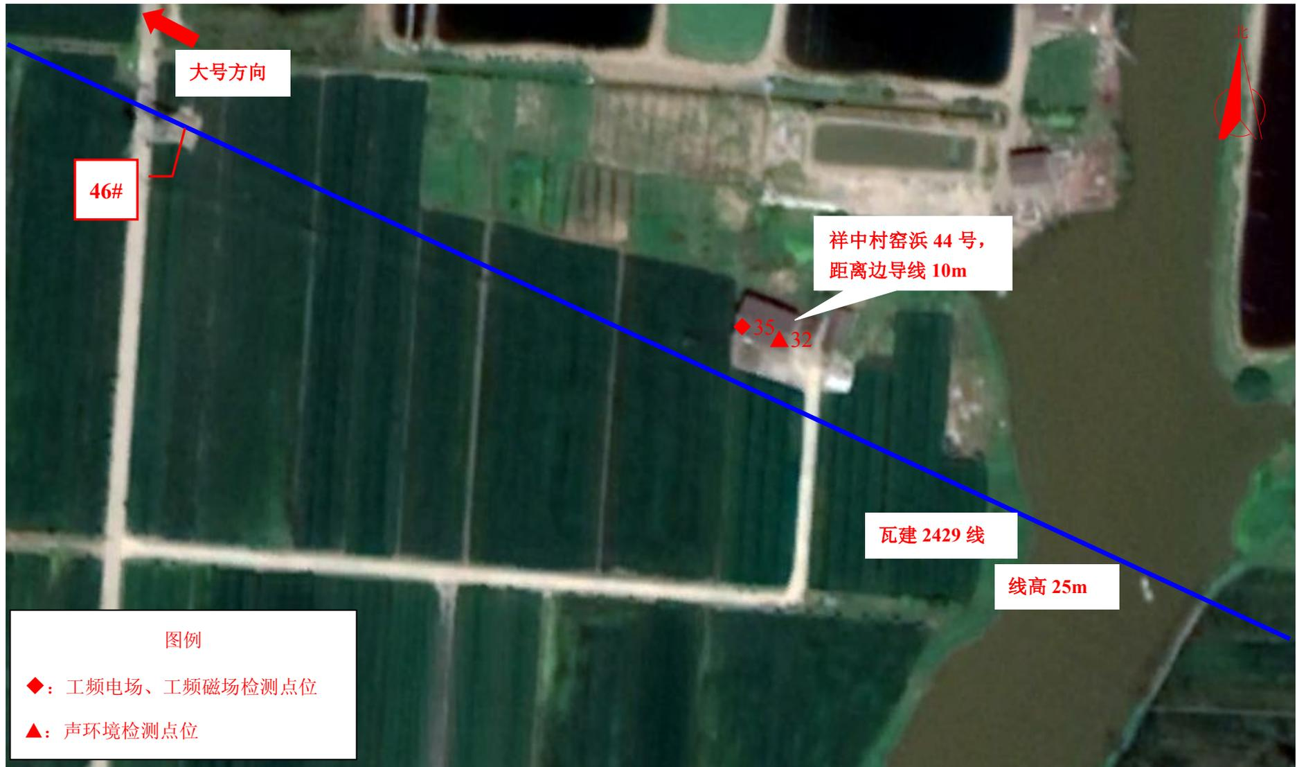
图 7-9 (26) 现场监测点位图 (220kV 瓦山输变电工程)
