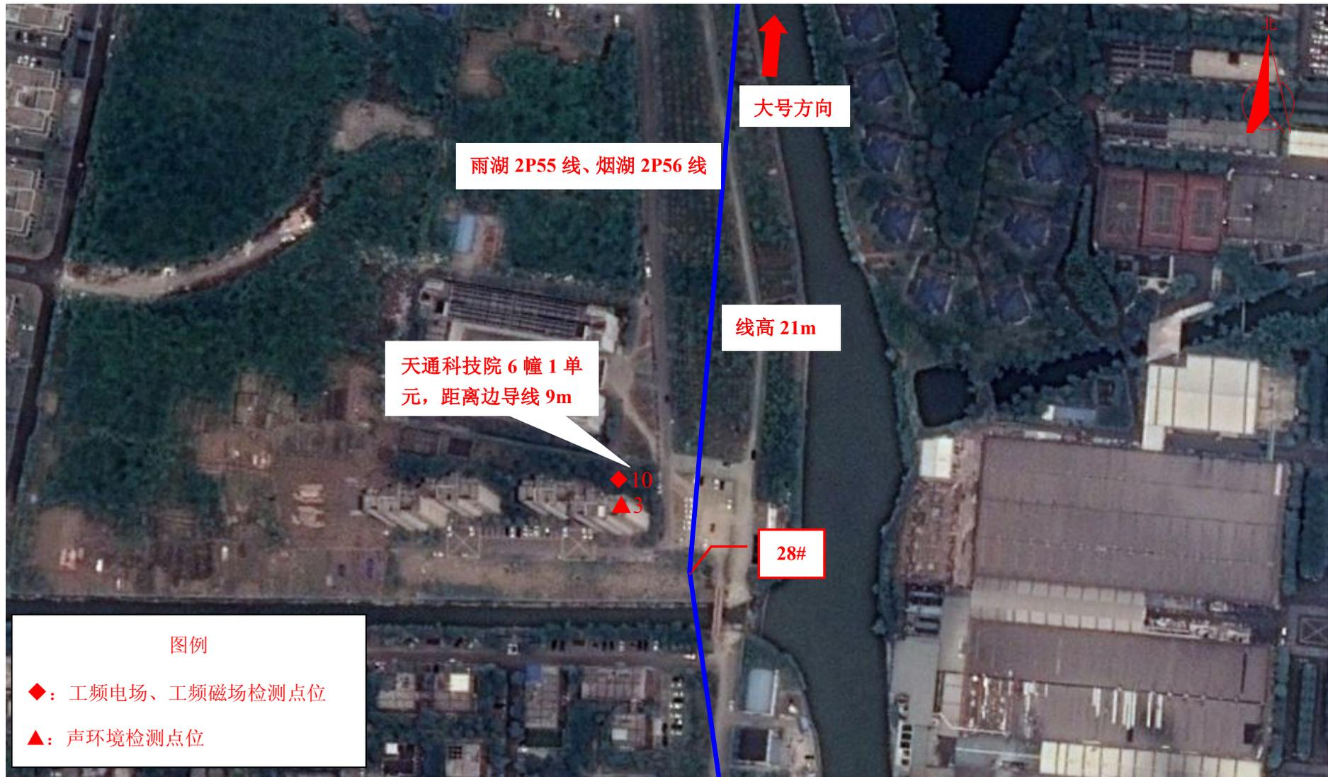
图 7-7 (7) 现场监测点位图 (220kV 雨湖 2P55 线/烟湖 2P56 线输电线路工程)
