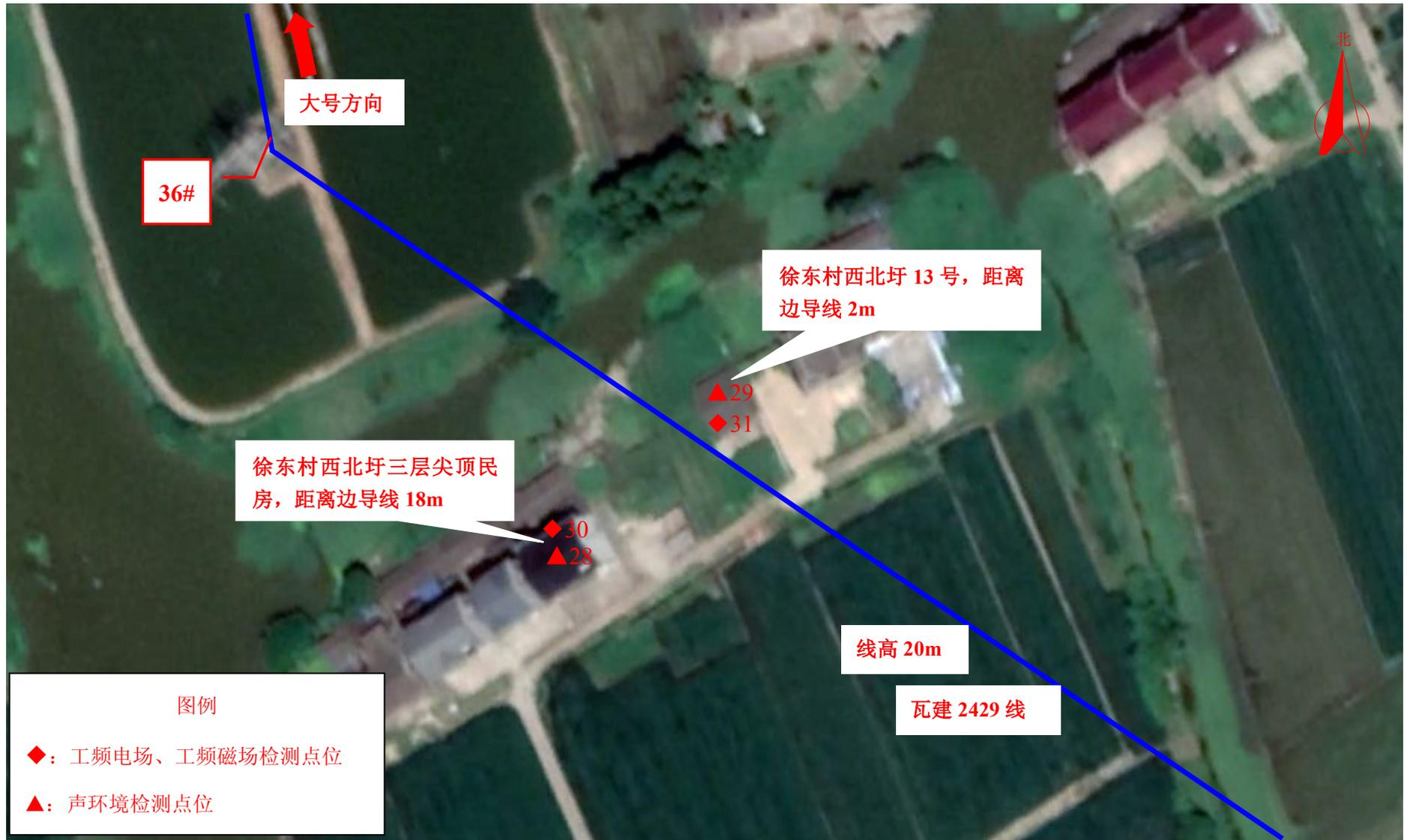
图 7-9 (22) 现场监测点位图 (220kV 瓦山输变电工程)
