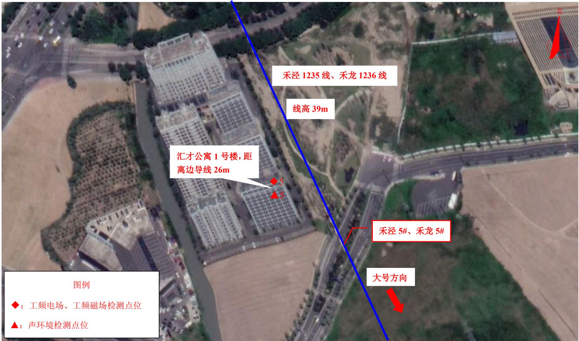
图 7-2 (2) 现场监测点位图 (110kV 泾水输变电工程)
