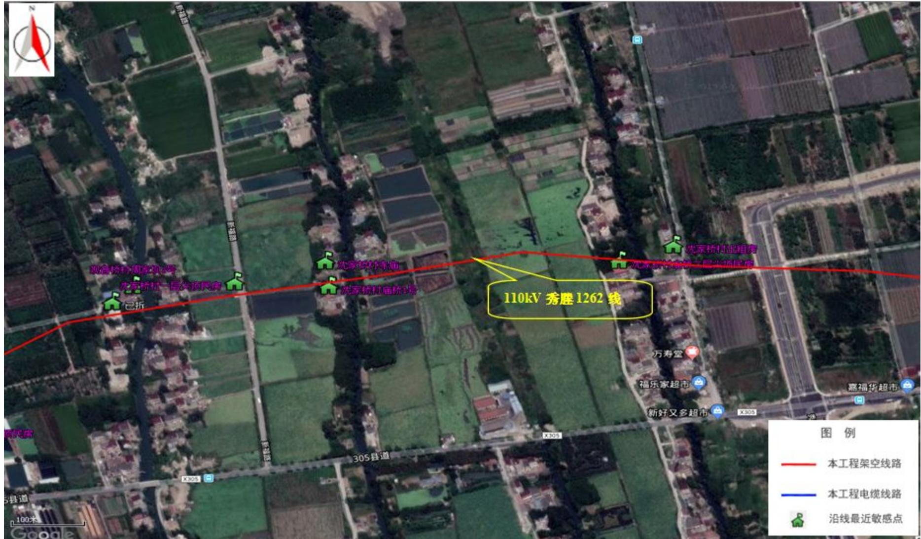
图 4-10 (4) 工程线路路径图 (110kV 秀隄 1262 线)
