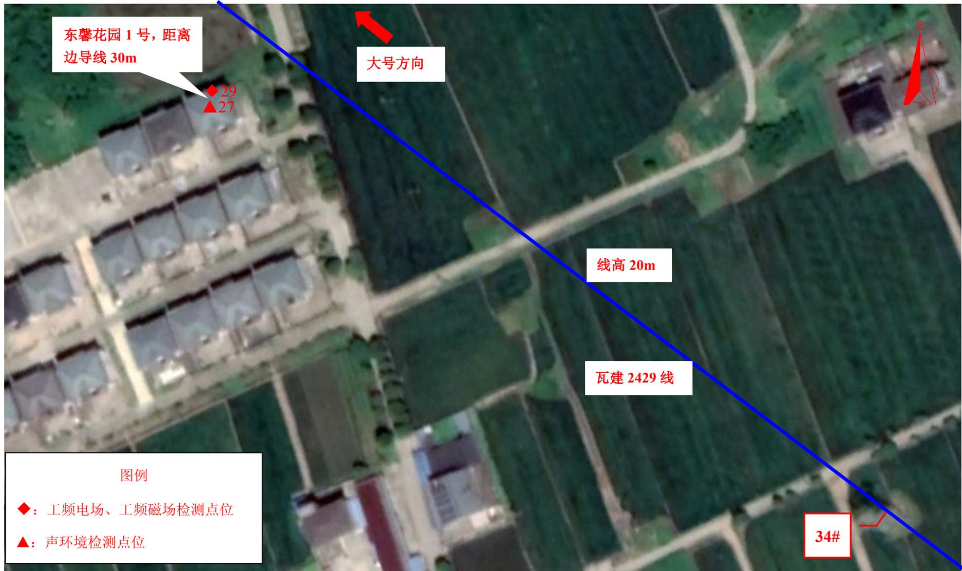
图 7-9 (21) 现场监测点位图 (220kV 瓦山输变电工程)
