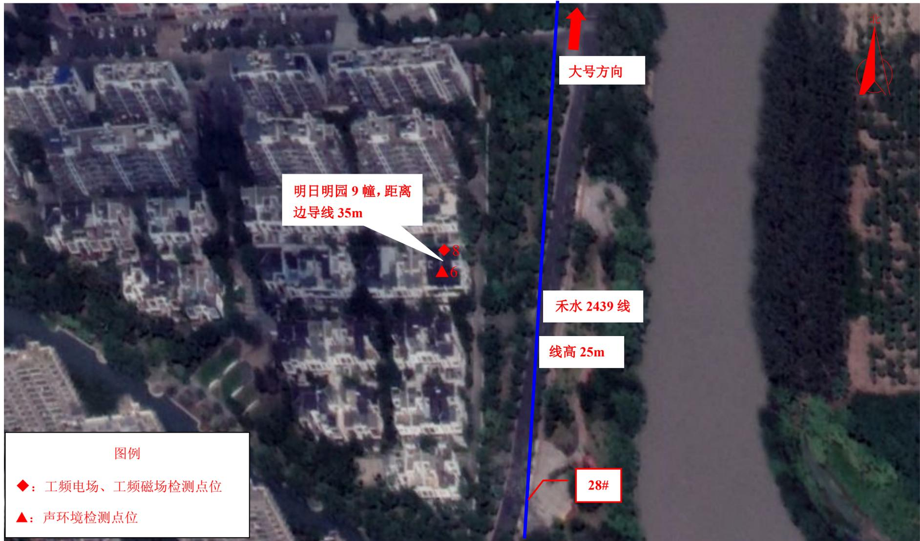
图 7-1 (7) 现场监测点位图 (220kV 禾城输电线路工程)
