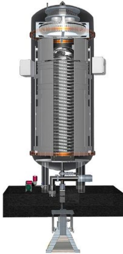
图 9-2 直立型加速器结构图
