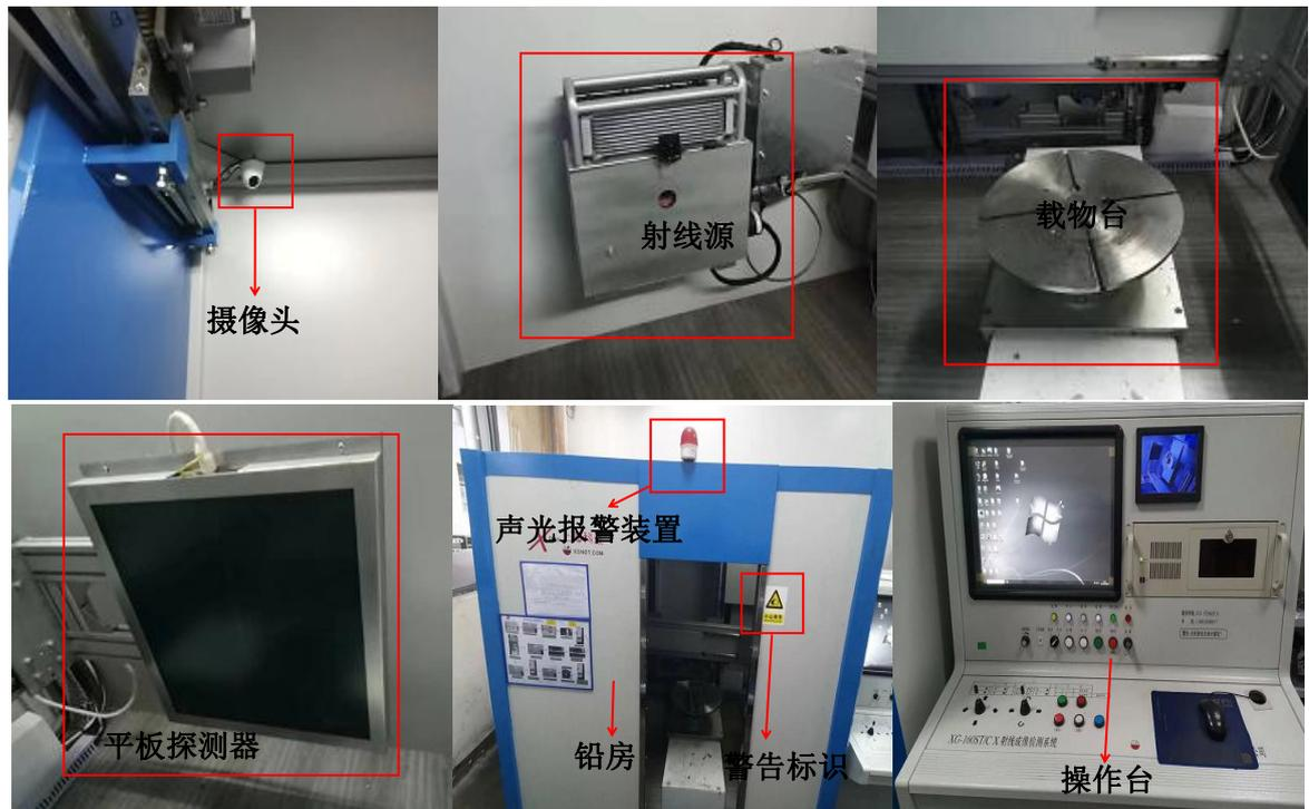
图9.1-1 X射线实时成像系统实物图
