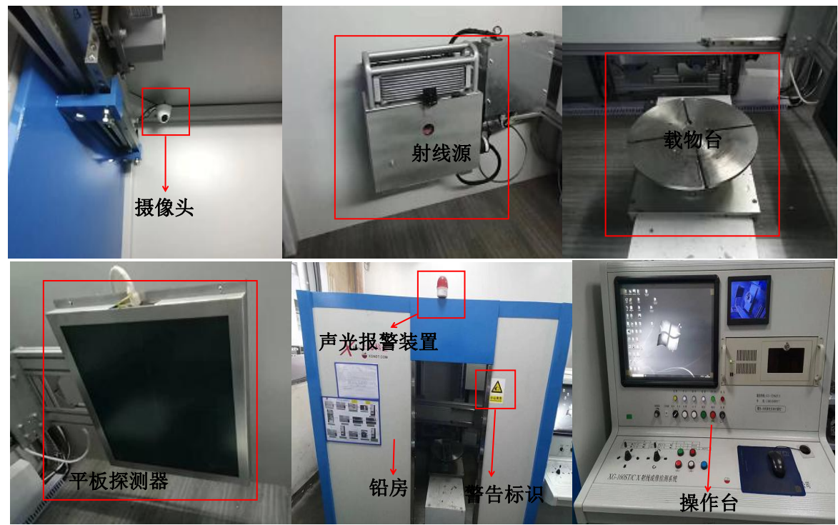
图9.1-1 X射线实时成像系统实物图
